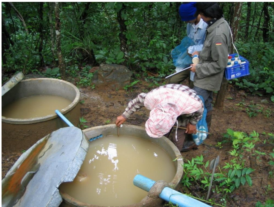
ภาพที่ 3.19 การเก็บตัวอย่างปริมาณน้ำไหลป่าและตะกอนที่ถูกล้างใน (ก) ถังรองรับน้ำและตะกอน (บ่อซีเมนต์) และ (ข) การวัดระดับน้ำในบ่อซีเมนต์
