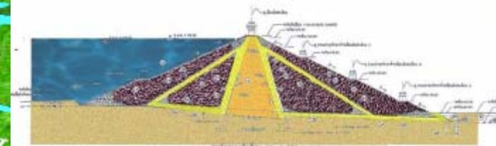
ชนิดของเขื่อนสันตะเคียน Earth Core Rockfill Dam ระดับสันเขื่อน +135.00 ม.รทก. ความยาวสันเขื่อน 1,270 เมตร ความสูงเขื่อน 80 เมตร
