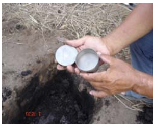
การเก็บตัวอย่างดิน เพื่อวิเคราะห์ความชื้นในดิน
