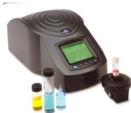
เครื่องหาความต้องการออกซิเจนทางเคมี (ภาคสนาม) ( Spectrophotometer instrument )
