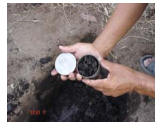
การเก็บตัวอย่างดิน เพื่อวิเคราะห์ความชื้นในดิน
