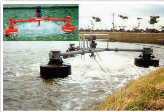
รูปแบบที่ ๖ เครื่องกลเติมอากาศแบบตีน้ำสัมผัสอากาศ “เครื่องตีน้ำชัยพัฒนา” (Chaipattana Aerator, Model RX-6)
