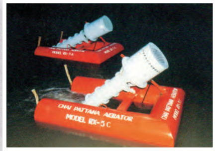
รูปแบบที่ ๕ เครื่องกลเติมอากาศระบบอัดและดูดอากาศ ลงใต้น้ำ “ชัยพัฒนาแอร์เจท” (Chaipattana Aerator, Model RX-5)
