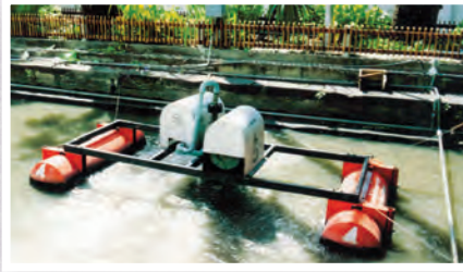
รูปแบบที่ ๓ เครื่องกลเติมอากาศระบบเป่าอากาศหมุนใต้น้ำ “ชัยพัฒนาซูเปอร์ฟองแอร์” (Chaipattana Aerator, Model RX-3)
