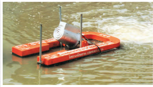
รูปแบบที่ ๕ เครื่องกลเติมอากาศระบบอัดและดูดอากาศ ลงใต้น้ำ “ชัยพัฒนาแอร์เจท” (Chaipattana Aerator, Model RX-5)
