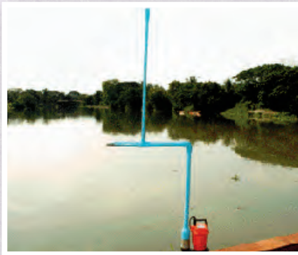
รูปแบบที่ ๔ เครื่องกลเติมอากาศแรงดันน้ำ “ชัยพัฒนาเวทจิวรี่” (Chaipattana Aerator, Model RX-4)
