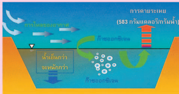
◀ ภาพที่ ๔ กระบวนการแทรกซึมของออกซิเจนจากอากาศลงใต้ผิวน้ำในบ่อบำบัดน้ำเสีย
