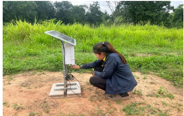
ศึกษาและสาธิตการเก็บข้อมูลอุณหภูมิและความชื้นในดินที่ระดับต่าง ๆ สำหรับวางแผนการจัดการปัญหาดินตื้น
